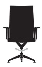
2 Drehbare Standsäule mit Rückstellautomatik nicht höhenverstellbar
