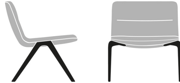
V-förmiger Fußbügel in Eichenschichtholz gebeizt nach Eiche Hauskollektion, stumpfmatt lackiert
